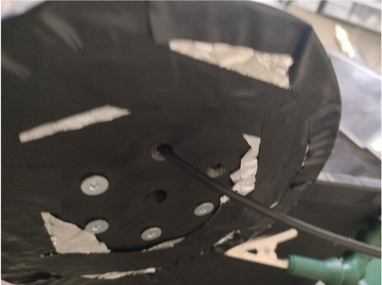
26. ábra. Koax kábel befűzve az egyik lyukba. (Én egy RG174 coax-ot használtam.)
