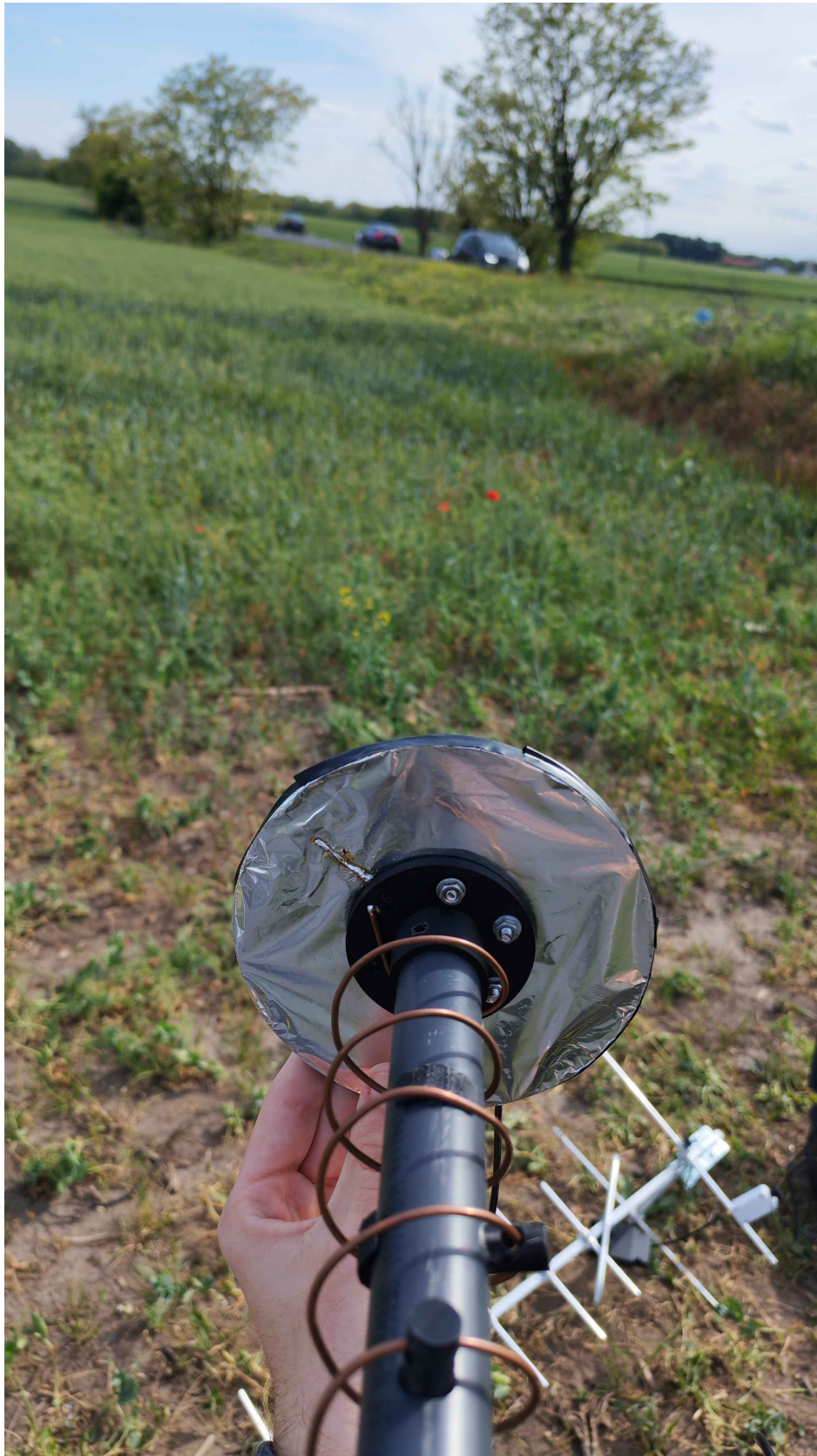
36. ábra. Látszik, hogy a földhöz viszonyítva melyik részének kell lefele néznie az antennának amennyiben oldalról veszünk.
