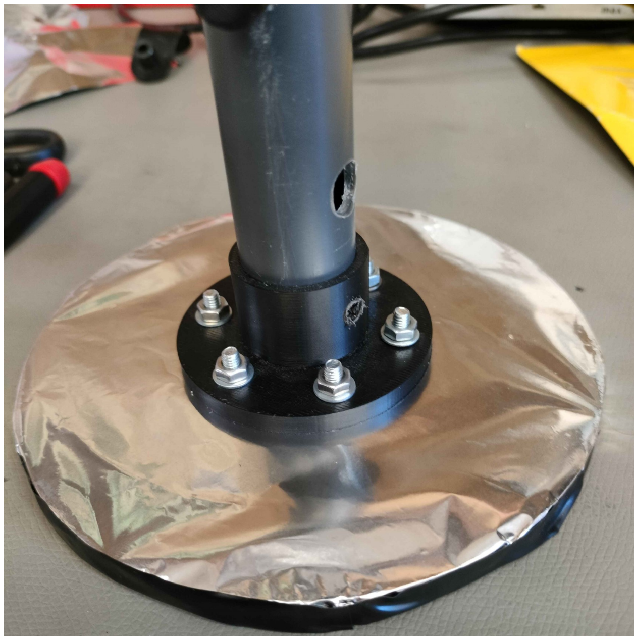
19. ábra. 5. lépés: Oszlop fogó becsavározása. Opcionálisan szigetelő szallaggal be lehet az oldal részt fedni, hogy kopásállóbb legyen.
