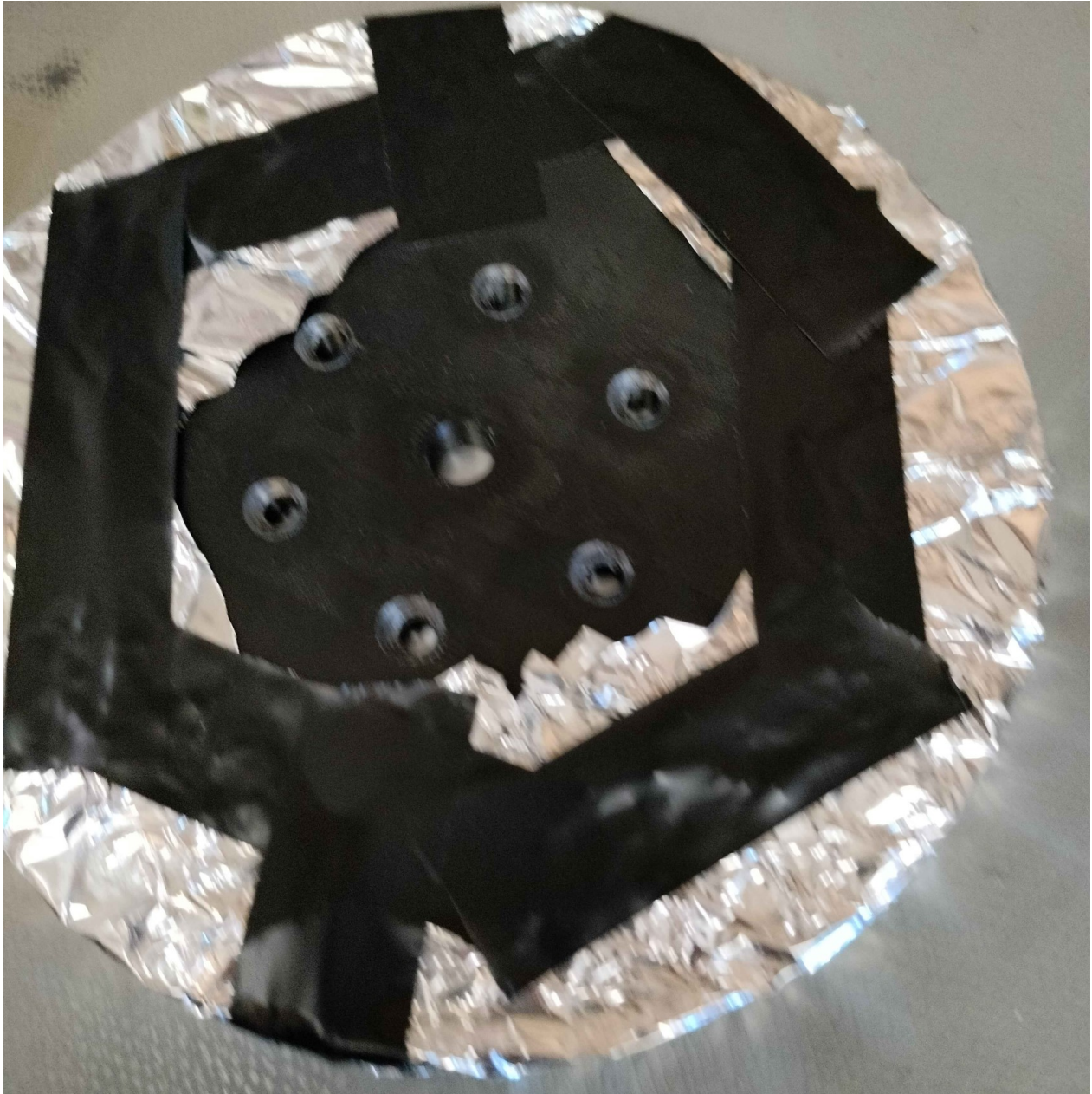
17. ábra. 3. lépés: Alufólia esetén a lap aljának stabilizálása flex tape-el.
