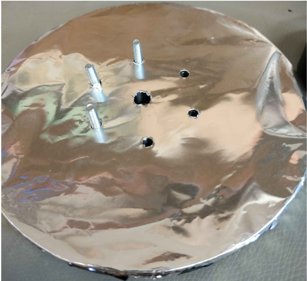
18. ábra. 4. lépés: Lyukak kifúrása és csavarok behelyezése.
